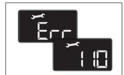
**Защитное отключение из-за низкого давления воды**
