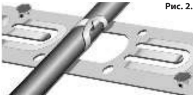
Монтажная лента предназначена для упрощения раскладки нагревательных секций и закрепления их на поверхности пола (рис. 2).
