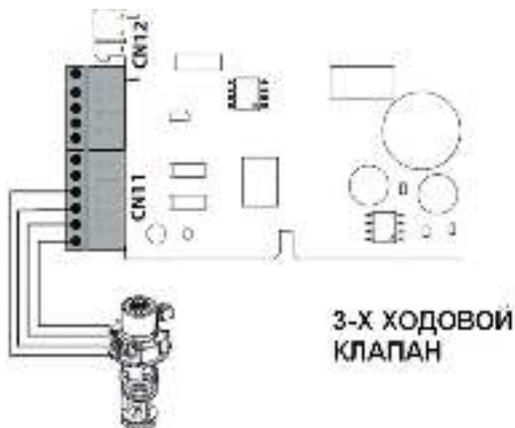
Для проверки шагового двигателя можно измерить сопротивление между указанными выводами. Если оно составляет от 80 до 100 Ом, это означает, что обмотки шагового двигателя целы.
