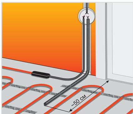
Датчик температуры пола устанавливается в монтажной трубке, в полу, на расстоянии 50 см от стены, на которой расположен терморегулятор. Трубка с датчиком внутри должна располагаться на равном расстоянии между витками кабеля для наиболее точного измерения температуры.
