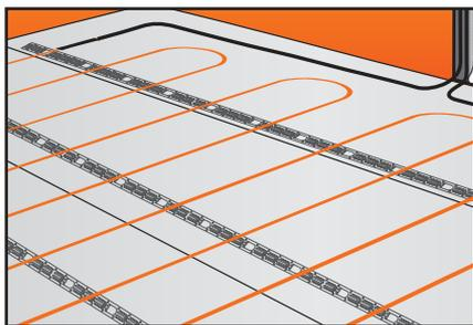
**4.6.** Если Вы используете цементно-песчаную смесь после раскладки нагревательного кабеля на теплоизоляции, сделайте в ней вырезы размером 5–8×15–20 см (в зависимости от шага укладки) для обеспечения лучшего сцепления стяжки с основанием. Вырезы должны располагаться в шахматном порядке между витками нагревательного кабеля. При применении наливного пола вырезы в теплоизоляции не нужны.
