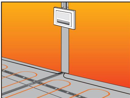
4.9. Измерьте сопротивление кабеля и датчика, сверьте с данными в инструкциях (паспортах) и зафиксируйте в п. 8.
