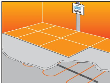
**4.13.** В случае использования в качестве декоративного напольного покрытия ламината, линолеума или коврового покрытия схема укладки нагревательного кабеля будет следующей:
