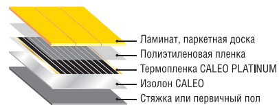
Рис. 27. Схема монтажа пленочного теплого пола под ламинат, паркетную доску
