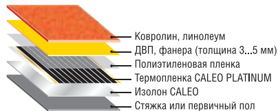
Рис. 28. Схема монтажа пленочного теплого пола под ковролин, линолеум
