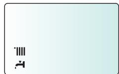
3. Запустите цикл принудительного автоматического удаления воздуха из контура отопления ("АТИВОЗДУХ"), для чего нажмите и удерживайте 5 с кнопку ESC. Запустится цикл продолжительностью примерно 7 мин. Для отключения этого режима, нажмите кнопку ESC (отмена).
