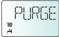
По окончании проверьте, полностью ли удален воздух из контура отопления, если нет, повторите цикл.
