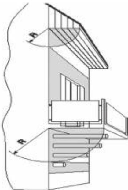
При размещении дымового канала под навесом, балконами и карнизами кровли зданий канал должен выходить за окружность, описанную радиусом  $R$ .
