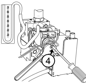
4. По окончании проверки затяните винт «2» и убедитесь, что он затянут плотно.
