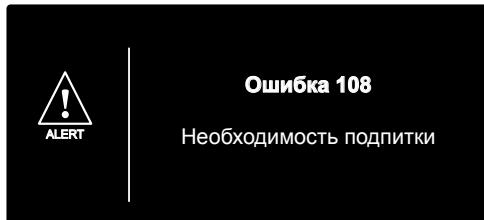
Проверьте давление воды по показаниям манометра на панели управления; при холодной системе значение должно быть от 0,6 до 1,5 бар.
