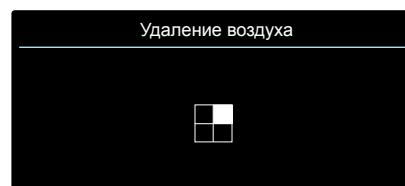
Запустится цикл продолжительностью примерно 7 мин. Для отключения этого режима, нажмите кнопку ESC (отмена).
