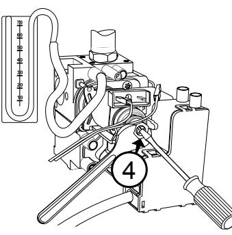
4. По окончании проверки затяните винт «2» и убедитесь, что он затянут плотно.
